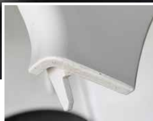
清洁前：模具残留物造成的零件污染
