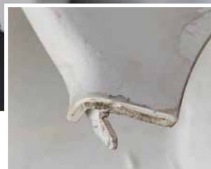
清洁过程中：使用肯天® MC1718/1719后从模具中拉出重度污染残留物的零件
