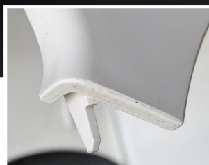
VOR DER REINIGUNG: Verunreinigte Teile durch Rückstände in der Form
